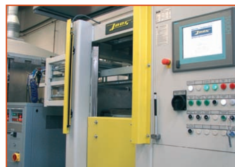
Abb.1: 800kN Laborpresse mit gekoppelter Kraft-/Positionsregelung, automatischem Materialtransfer und IR Vorheizung zur Gradierung eigenverstärkter Thermoplastverbunde
