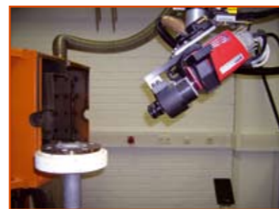
Abb. 2: Roboterassistierte optische Deformationsmessung
