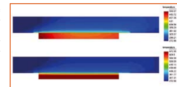
Abb. 2: Temperaturverlauf in gekoppelter Strömung und Struktur, der die Abkühlung der heißen Struktur in 20 Sekunden zeigt.
